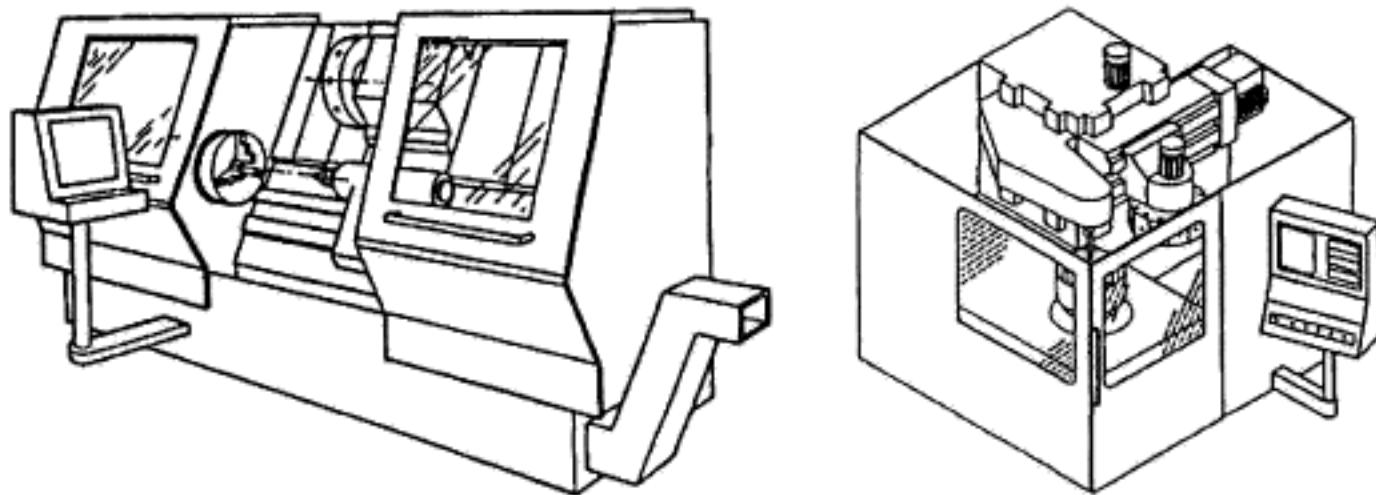
а) Пример горизонтального токарного станка с ЧПУ
