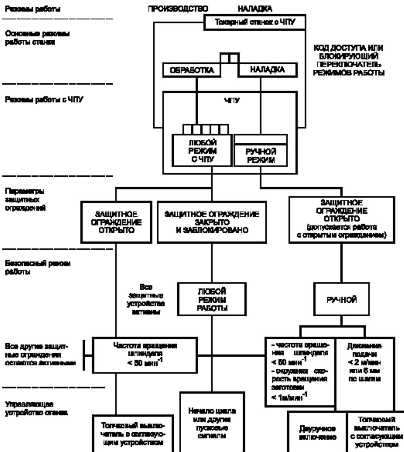
Рисунок 2 — Схематическое изображение профилактических мероприятий
