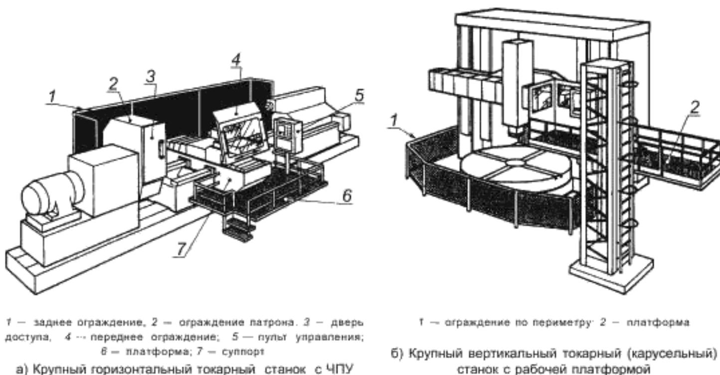
Рисунок 1 — Примеры крупных токарных станков
