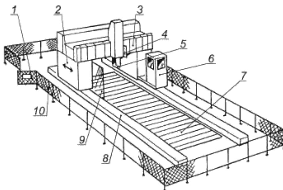
1 — доступ с блокировкой; 2 — перемещаемые стойки; 3 — телескопические стальные щитки; 4 — дополнительный пульт управления; 5 — фреза; 6 — рабочая станция, закрытая с трех сторон. Перемещение со стойками; 7 — стол станка; 8 — крышки над направляющими (стакна); 9 — ограждение мигающего типа; 10 — ограждение по периметру (забор)
