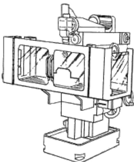
б) Ограждение с шарнирной дверью
