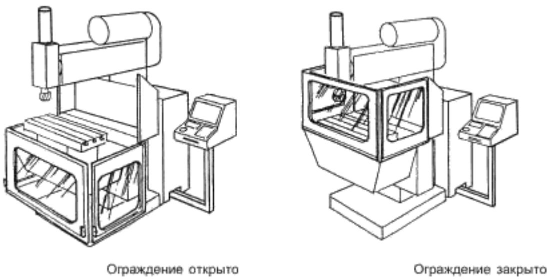
а) — Пример сблокированного ограждения для фрезерного станка-автомата
