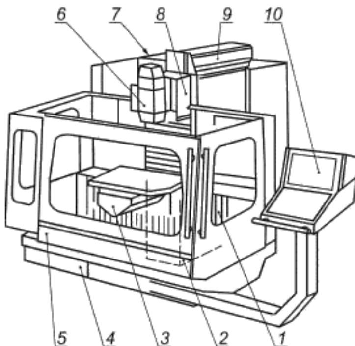
1 — стойка станка и привод подачи, ось Y; 2 — поперечный суппорт с вертикальным столом и приводом подачи, ось X; 3 — рабочий стол — неподвижный или вращающийся; 4 — система подачи СОЖ, система охлаждения; 5 — кабина; 6 — фрезерная головка с вертикальным шпинделем; 7 — электрический шкаф; 8 — фрезерная головка с горизонтальным шпинделем и приводом подачи, ось Z; 9 — главный привод; 10 — пульт управления
