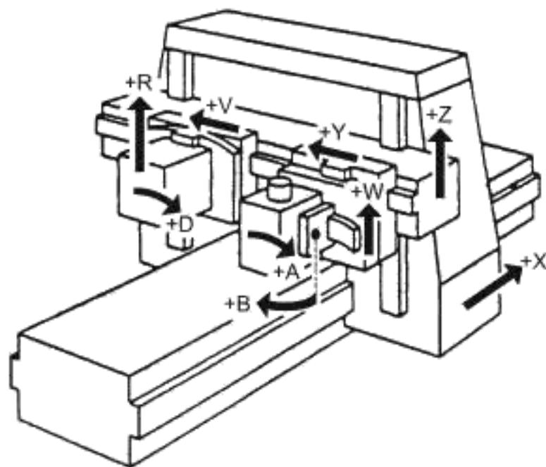
Рисунок С.5 — Продольно-фрезерный станок порталного типа
