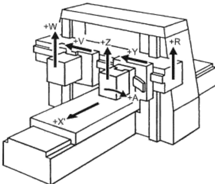
Рисунок С.4 — Продольно-фрезерный станок
