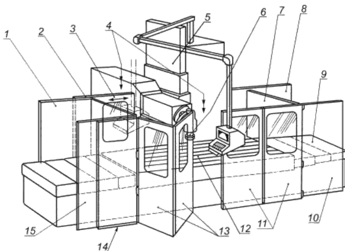
1, 8, 10, 15 — неподвижное ограждение; 2, 7 — перемещаемое ограждение, смонтированное на конце стола; 3 — блокированное перемещаемое ограждение для доступа оператора; 4 — альтернативные положения оператора; 5, 9 — стальные телескопические крышки; 6 — фреза; 11, 13 — створчатые двери (сблокированные); 12 — стол станка; 14 — положение створчатых дверей при загрузке стола
