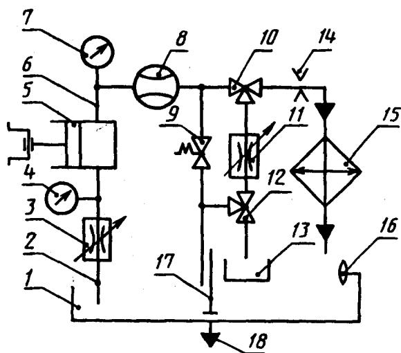
1 — расходная емкость; 2 — всасывающий трубопровод; 3 — дроссель всасывающего трубопровода; 4 — мановакуумметр; 5 — испытуемый насос; 6 — нагнетательный трубопровод; 7 — манометр; 8 — расходомер; 9 — предохранительный клапан; 10 — трехходовой кран; 11 — дроссель; 12 — трехходовой кран или перекидная воронка; 13 — мерный бак; 14 — набор дроссельных шайб; 15 — теплообменник; 16 — указатель уровня жидкости; 17 — мешалка; 18 — слив жидкости
