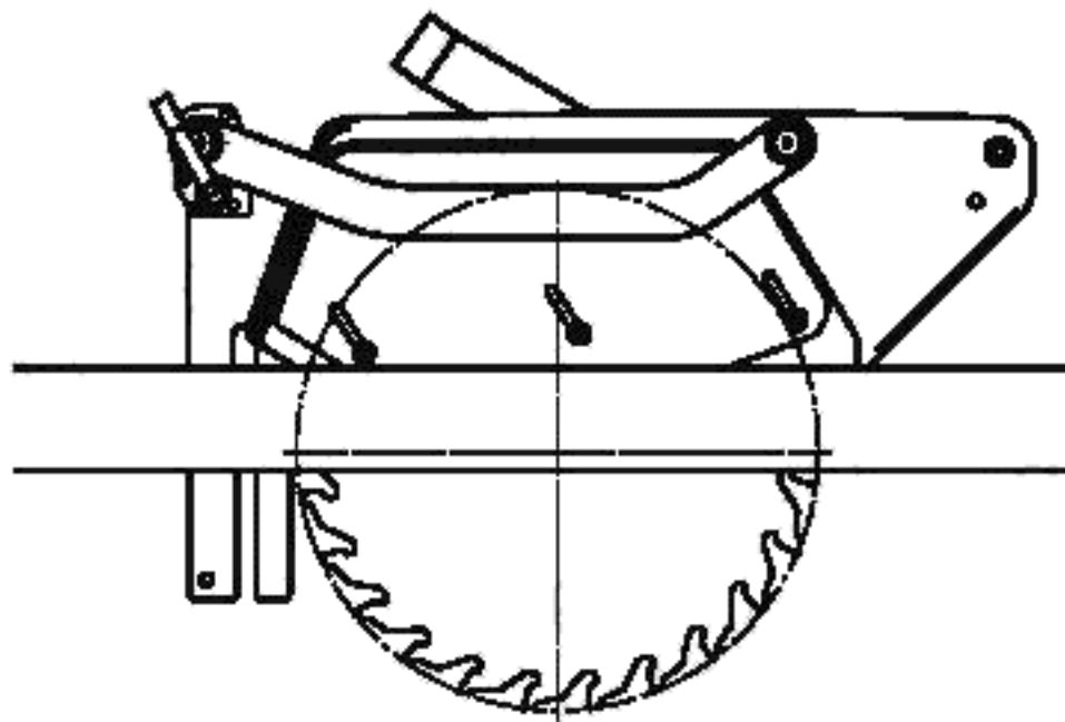
Рисунок 5 — Пример автоматически закрывающегося верхнего защитного кожуха
