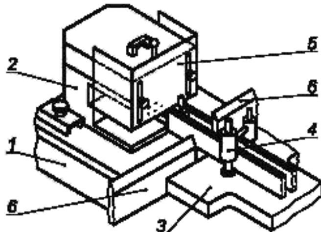
1 — станина; 2 — защитное ограждение (кофх); 3 — дополнительный передвижной стол (каретка); 4 — устройство прижима заготовки; 5 — регулируемое перемещаемое защитное ограждение; 6 — защитное ограждение, закрепленное на передвижном столе (каретке)
